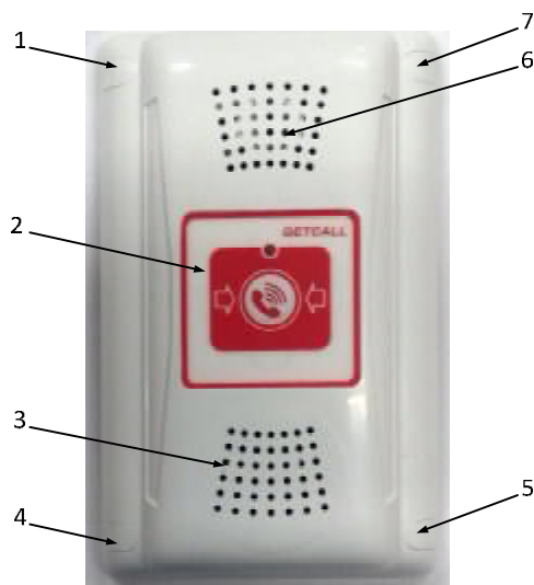
Рисунок 1. Внешний вид пульта GC-3001W3 1,4,5,7-заглушки 2- кнопка вызова 3 - динамик 6 - микрофон
