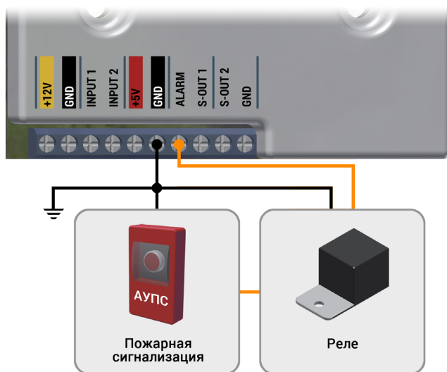
Рисунок 21 - Подключение АУПС к турникету.
