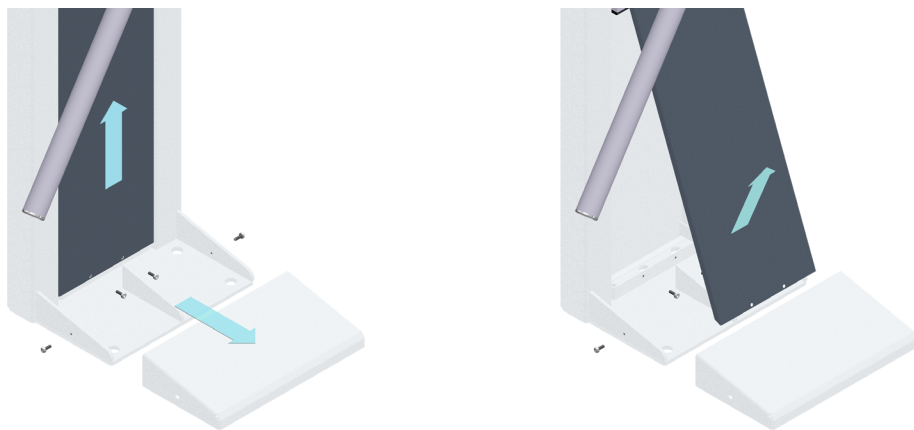
Рисунок 26 – Демонтаж центрального кожуха турникета.
