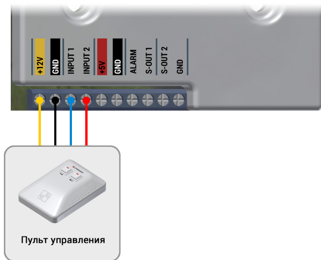
Рисунок 18 - Подключение ПДУ к турникету.
