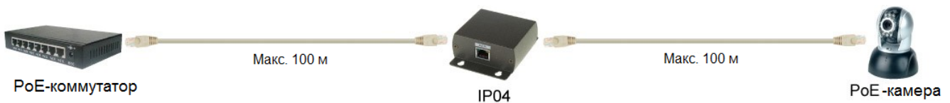
Рис. 4 Схема подключения IP04.
