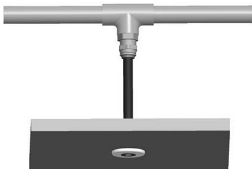
Рисунок 5. КАПИЛЛЯРНАЯ ТРУБКА С ВОЗДУХОЗАБОРНЫМ ОТВЕРСТИЕМ
