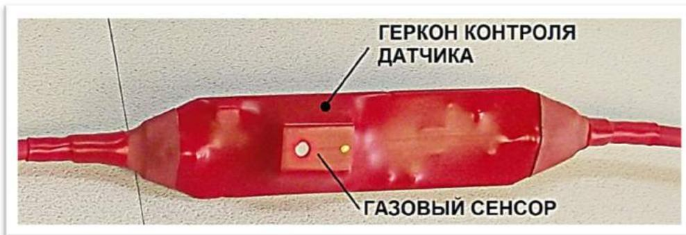
Рис.9. Внешний вид газового датчика КХ "ProCab" ИПГМ, ИПКМ.
