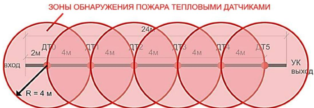
Рис.4. Зона мониторинга тепловыми датчиками КХ “ProCab” ИП101-1-Р-МТ.
