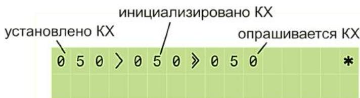
При старте блока обработки на экране в первом поле указывается номер последнего КХ, равный количеству КХ, установленных в конфигурации извещателя. Остальные поля равны нулю. В правом верхнем углу символ «>» показывает действие БО – проведение инициализации.
