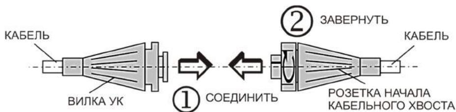
Рис.10. Соединение кабельных хвостов
