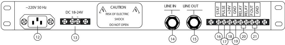
**13. РАЗЪЕМ 220В** - Разъем для подключения питающего напряжения 220В 50 Гц. Питающее напряжение подается через кнопку POWER (позиция 11).
