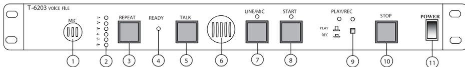
**1. МИКРОФОН** – Встроенный высокочувствительный микрофон для оперативной записи сообщения без использования линейного входа блока.
