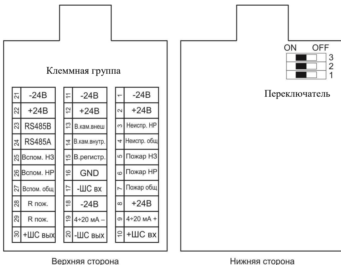
Рисунок 8 – Клеммная плата извещателя
