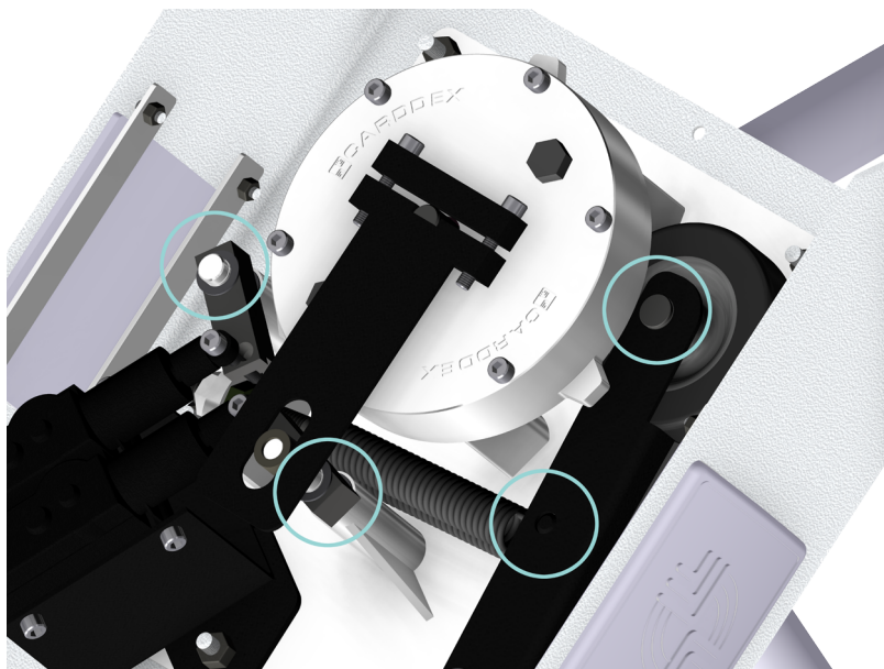
Рисунок 42 – Места смазки подвижных частей.
