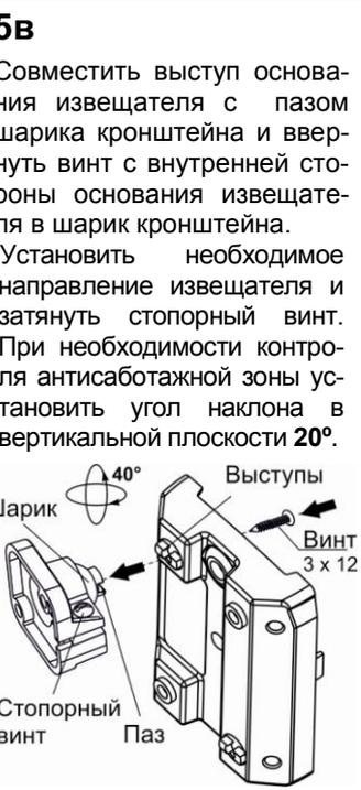
Кронштейн обеспечивает поворот извещателя в горизонтальной и вертикальной плоскостях на  $40^\circ$
