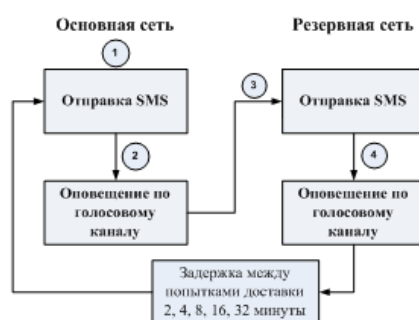
Рис. 4.3. Алгоритм оповещения в режиме индивидуальной охраны
