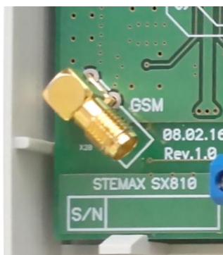
Рис. 5.4. SMA-разъем для подключения GSM-антенны
