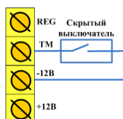
Рис. 10.3. Схема подключения скрытого выключателя
