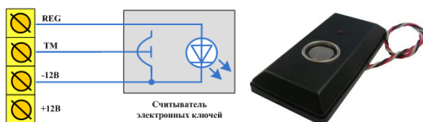
Рис. 10.1. Схема подключения считывателя Touch Memory
