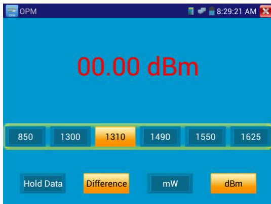
Рис. 3.3.15-2 Измерение относительной оптической мощности
