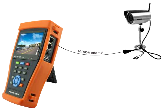
Рис 3.2.1-1. Подключение тестера к IP-камере.
