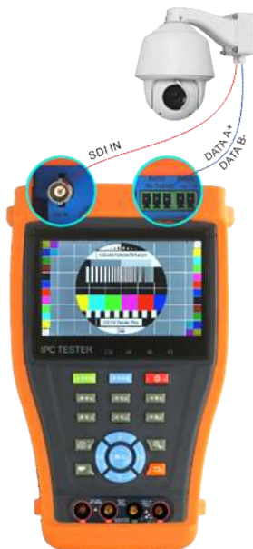
Рис 3.2.3-1 Подключение тестера к аналоговой камере высокого разрешения.
