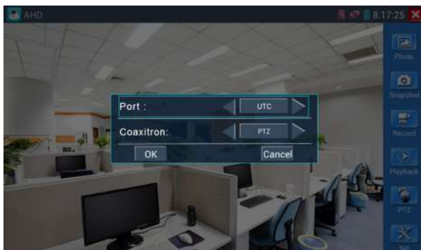
Рис.3.3.8.-3 Настройка параметров PTZ по коаксиальному кабелю
