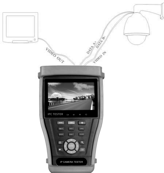
Рис 3.2.2-1 Подключение тестера к аналоговой камере.
