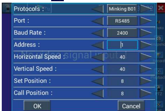
Рис.3.3.1-2 Окно настройки протокола управления камерой (RS485)
