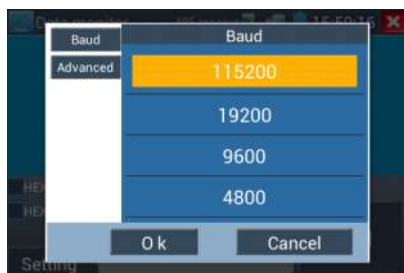
Рис.3.3.14-1 Настройка мониторинга данных по протоколу RS485
