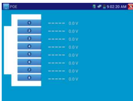
Рис. 3.3.21-1 Напряжение PoE на линиях кабеля витой пары
