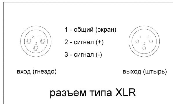
Рис.3. Функциональное назначение выводов разъемов XLR.
