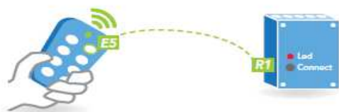
A-1a Привязка передатчика к приемнику
