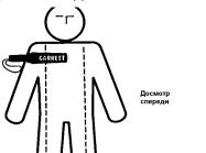
При работе над металлизированным полом может появиться необходимость нажатии удерживании кнопки устранения помех.
